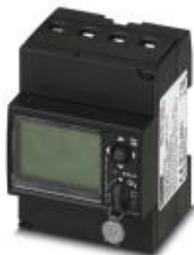
Drei-Phasen-Energiemessgerät zur Wirkleistungsmessung in Netzen bis 460 V / 65 A, mit 3 digitalen Eingängen und RS-485-Schnittstelle, zertifiziert gemäß MID-Richtlinie
