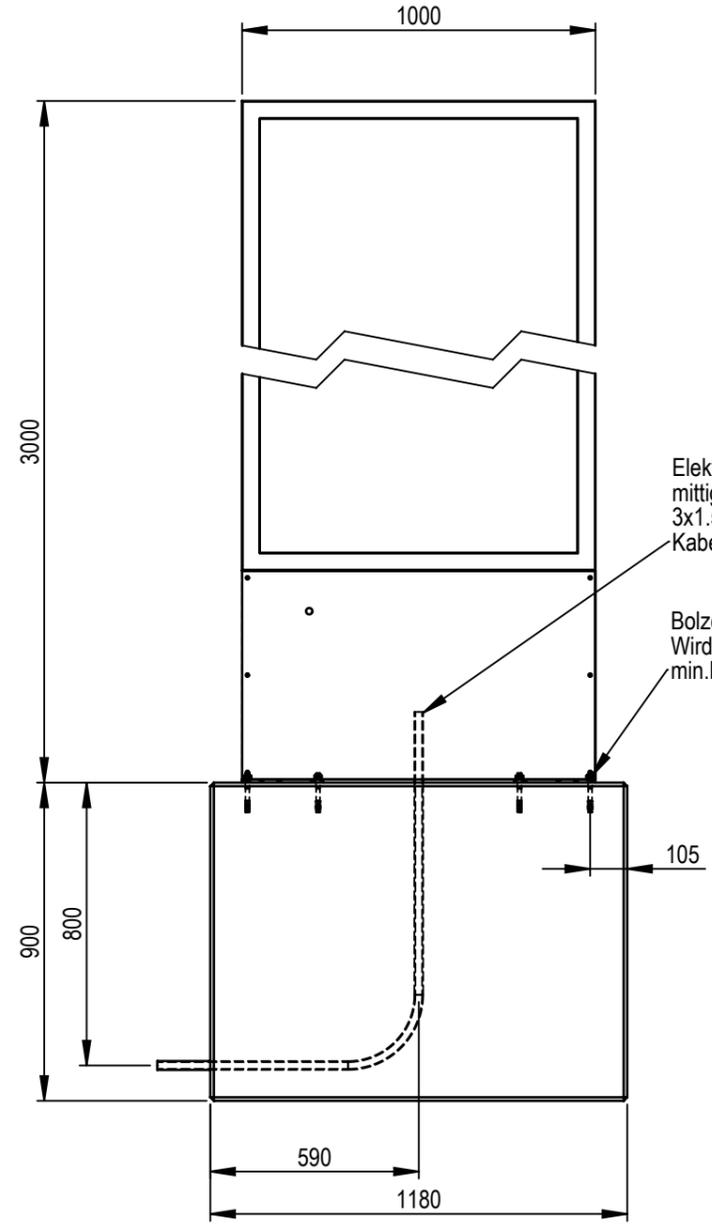
Elektrozugang genau mittig Fundament/Pylone
